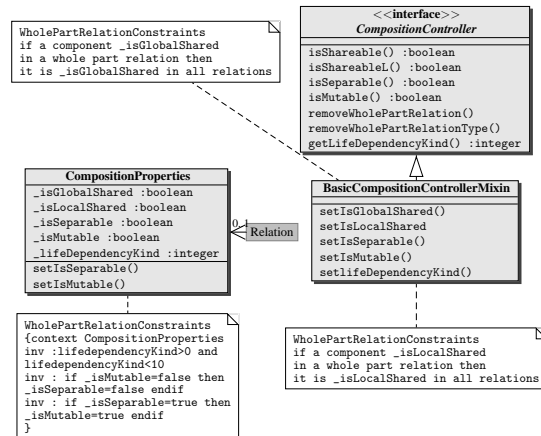
Figure 3. Modèle UML du composition-controller
